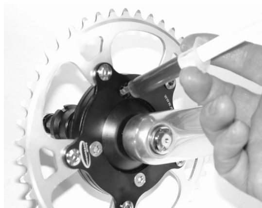
Abb. 7: Schmieren mit dem Spezialfett aus der handlichen 5ml-Ampulle
