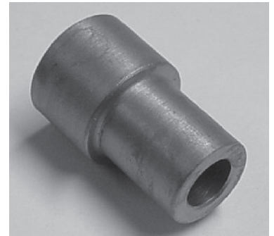
Röhrchen zum Abdrücken der Kurbel mit Standard-Kurbelabdrücker
